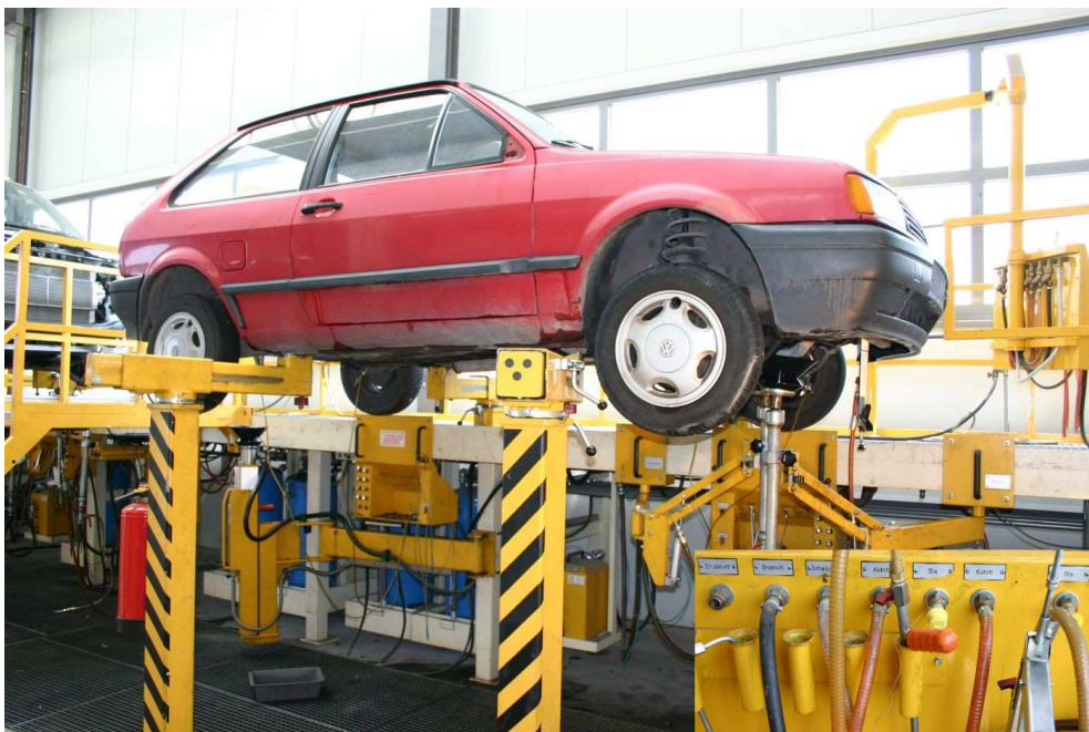
Abbildung 13: Entnahme aller Betriebsflüssigkeiten mittels moderner Technik
