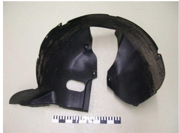
Abbildung 3: Radhausschale aus Polypropylen (PP) Rezyklat
