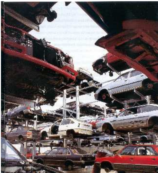
Abbildung 16: Trockengelegte Karossen im Hochregallager
